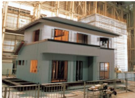
実物大の住宅に地震波を加え、耐震性能を実証
