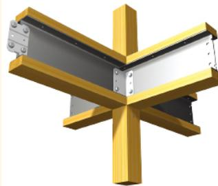
災害や経年劣化によってたわみやすい梁。そこに鉄を入れて補強したのがテクノビームという、パナソニックオリジナルのハイブリッド梁です。軽量H型鋼を芯材に上下を木で挟んだオリジナル複合梁で、抜群の強度を誇ります。
